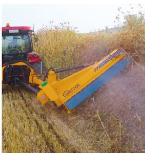
octogonal POLSER (conception 100% SERRAT) avec des disques de renfort internes. Marteaux garantis contre la casse. Qualité de coupe et robustesse à parts égales, le modèle PRO+ est idéal si vous cherchez une machine fiable avec une longue durée de vie. (Fig 2) ABATIBLE PRO+: Broyeur repliable pour tracteurs de 130cv à 220cv. Largeurs de travail de 3,80m à 6,30m. Soeur jumelle du modèle PRO+ mentionné ci-dessus. Les deux têtes de cette machine se superposent
