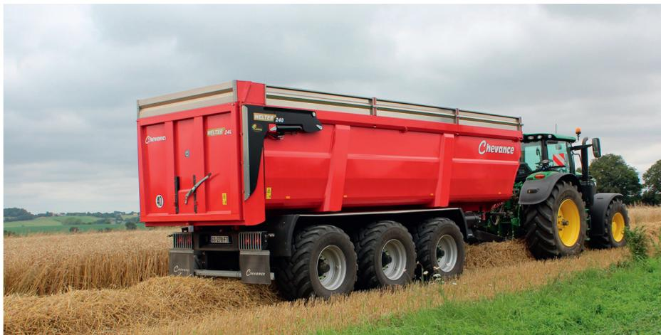
**C**hevance complète sa gamme de bennes 3 essieux WELTER 240 avec des côtés de caisse monobloc hauteur 1,80m (variante des côtés hauteur 1,50m déjà de série).
