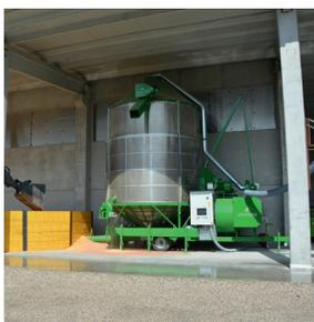
lité optimale. Les coffrets de démarrage programmables pour ventilateurs AIRFLOW MANAGER équipent des installations existantes ou neuves et autorisent la programmation du démarrage et de l'arrêt en fonction d'une température de consigne et pour une durée définie.
