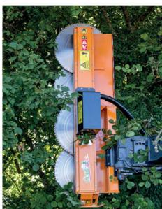
ou plusieurs lames de scie et/ou plateaux à couteaux pour tailler tous types de diamètres de branches.
