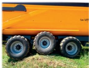
**S**on PTAV allant de 4,8 t à 8 t 6 soit 30 % plus légère qu'une benne classique. Elle possède une caisse volumineuse et l'absence de châssis sur celle-ci lui permet donc de transporter plus de matière en réalisant des économies de carburant. Elle reste aujourd'hui une benne inégalée sur le marché.
