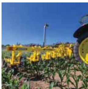
Bineuse ROW MASTER RN avec guidage caméra HD et colorimétrique
